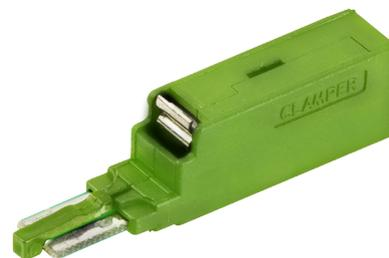
O Módulo Protetor Normal MP-N-ER-CP (G), com tensão de disparo entre 200 a 300 Vcc e sem proteção em série proporciona conexão à rede e protege os equipamentos de telecomunicações para sistemas STFC e xDSL contra sobretensões conduzidas a partir da rede externa.
