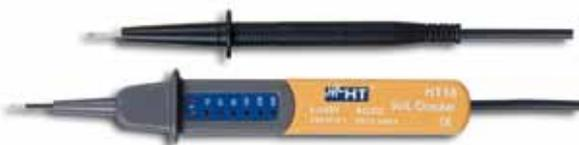
El modelo buscapolos tipo lápiz HT18 permite verificar con extrema rapidez la presencia de tensión CA/CC indicando el valor de la tensión mediante LEDs desde 6 hasta 400V tanto en Corriente Continua como Alterna.
