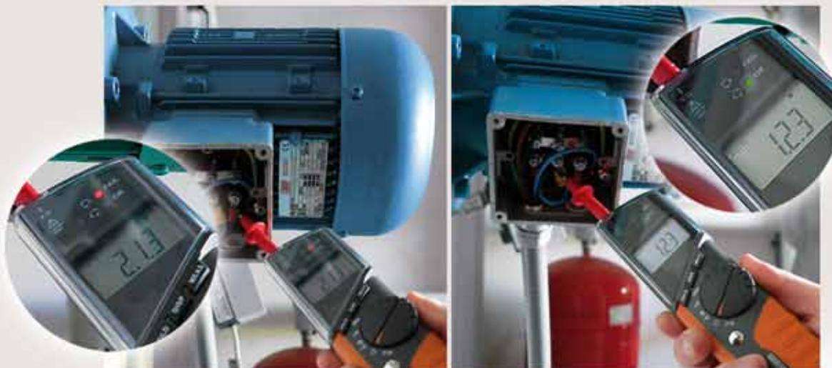
*Prueba del sentido cíclico incorrecto: indicación "213" y LED rojo encendido*
