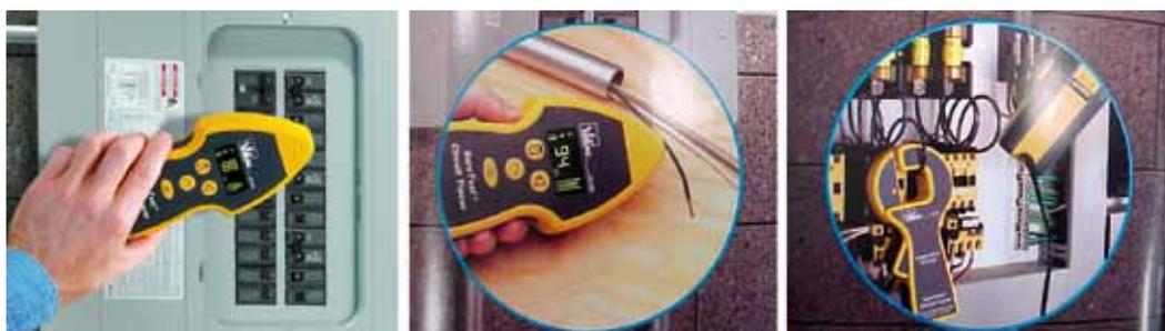
Configurando la correcta sensibilidad, el receptor está en condiciones de encontrar con precisión la señal emitida del transmisor y reconocer particulares interruptores y/o fusibles dentro de un cuadro eléctrico.
