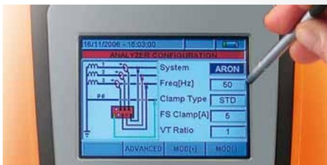
Amplio visualizador gráfico a color con pantalla táctil para uso con puntero
