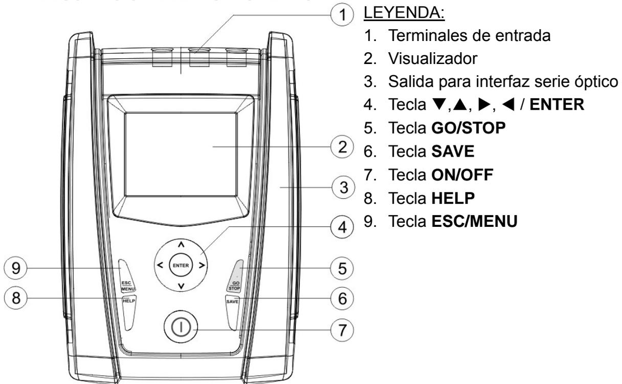
Fig. 1: Descripción parte frontal del instrumento
