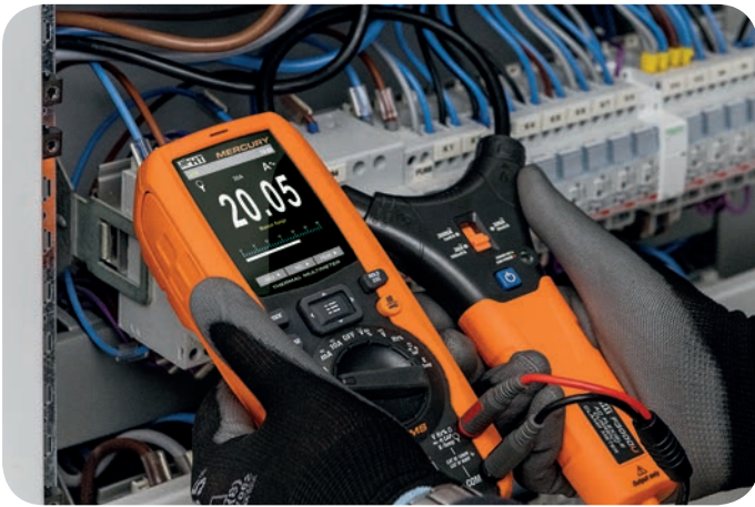
Medida de Corriente CA a través de transductor flexible hasta 3000ACA.
