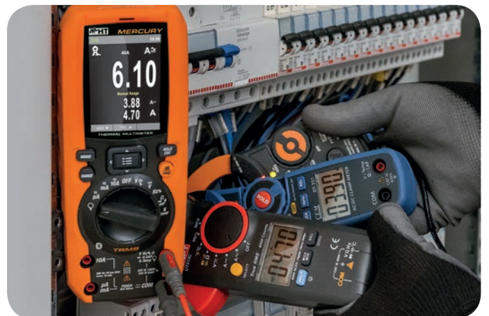
Comparación entre lecturas: 3.9A con pinza RMS, 4.7 A con pinza TRMS, 6.1A (lectura correcta) con pinza CA+CC.
