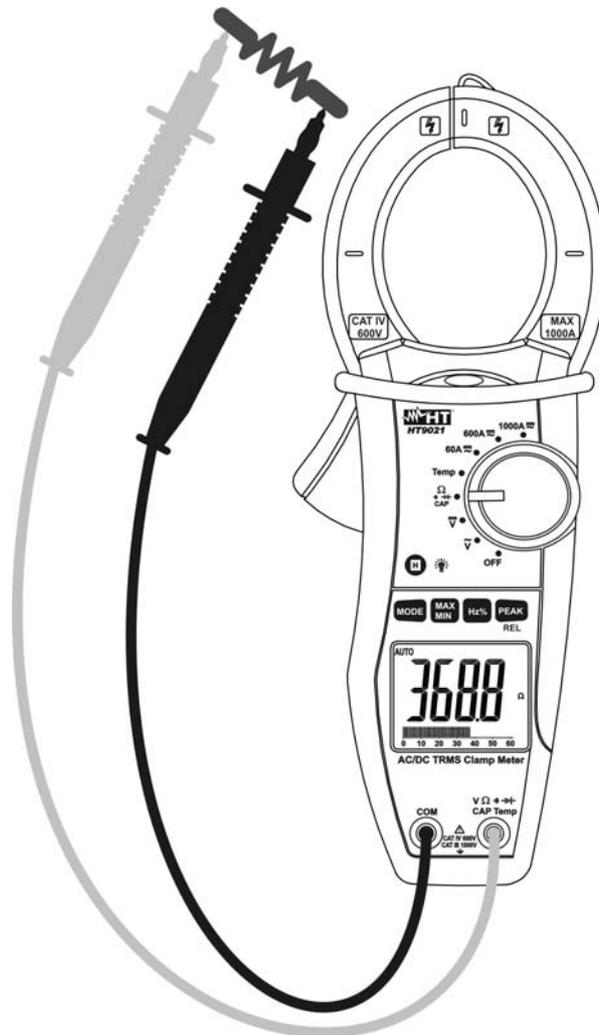
Fig. 4: Uso de la pinza para la medida de la Resistencia
