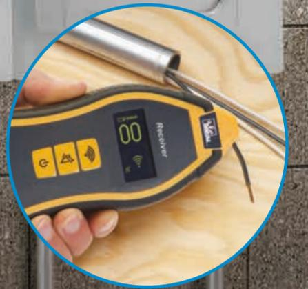
Se pueden clasificar cables individuales, se pueden localizar los circuitos abiertos y se pueden aislar los cortocircuitos.
