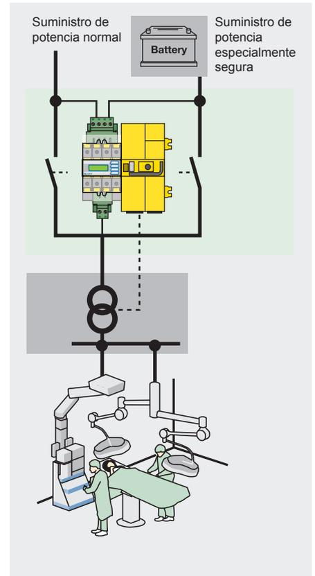
Sistema IT con dos cables de alimentación y una fuente de suministro de seguridad especial
