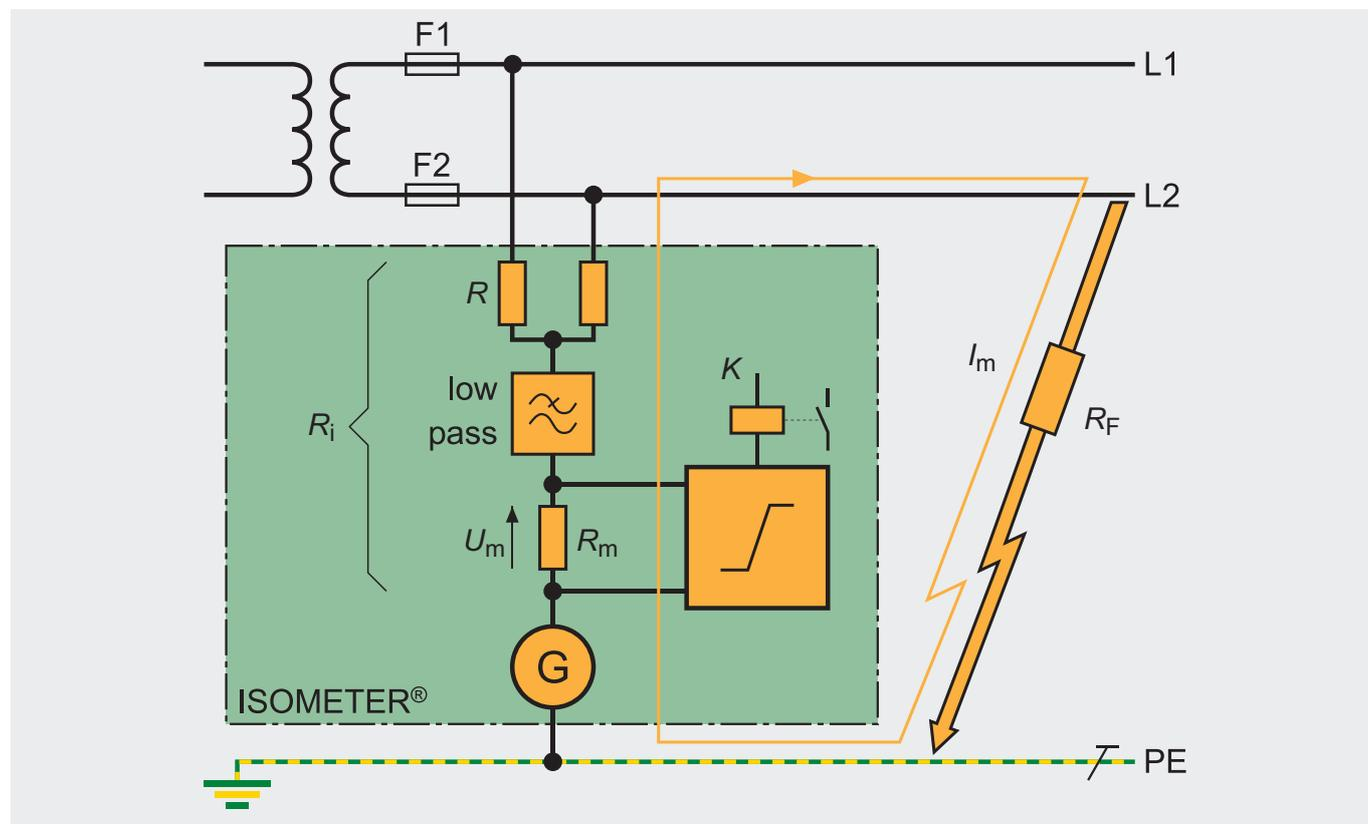
Principio de funcionamiento del monitor de aislamiento
