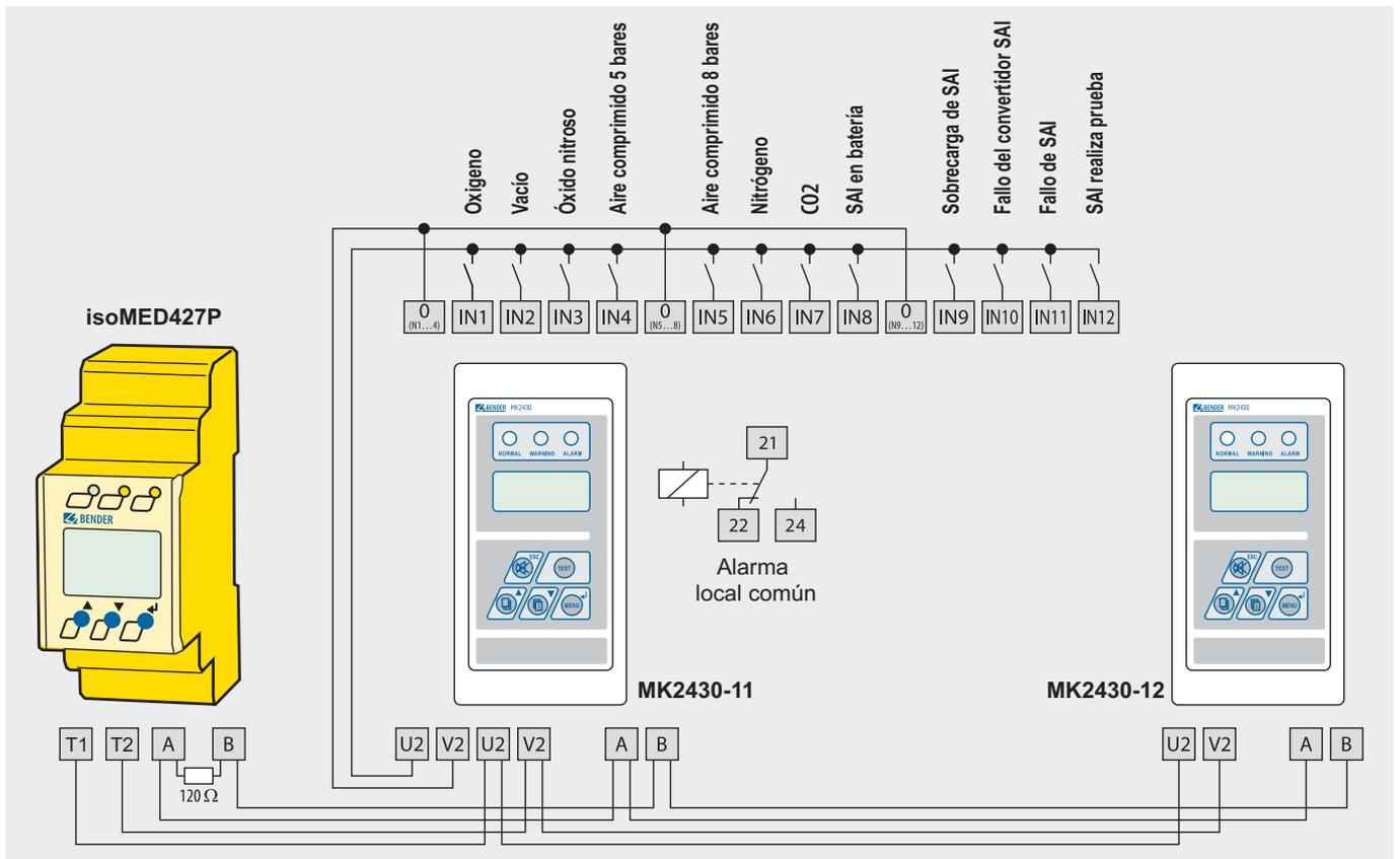
Vigilante isoMED427P de aislamiento, carga y temperatura, repeticor de alarmas MK2430-12 y MK2430-11 con 12 entradas digitales para comunicación e información adicional
