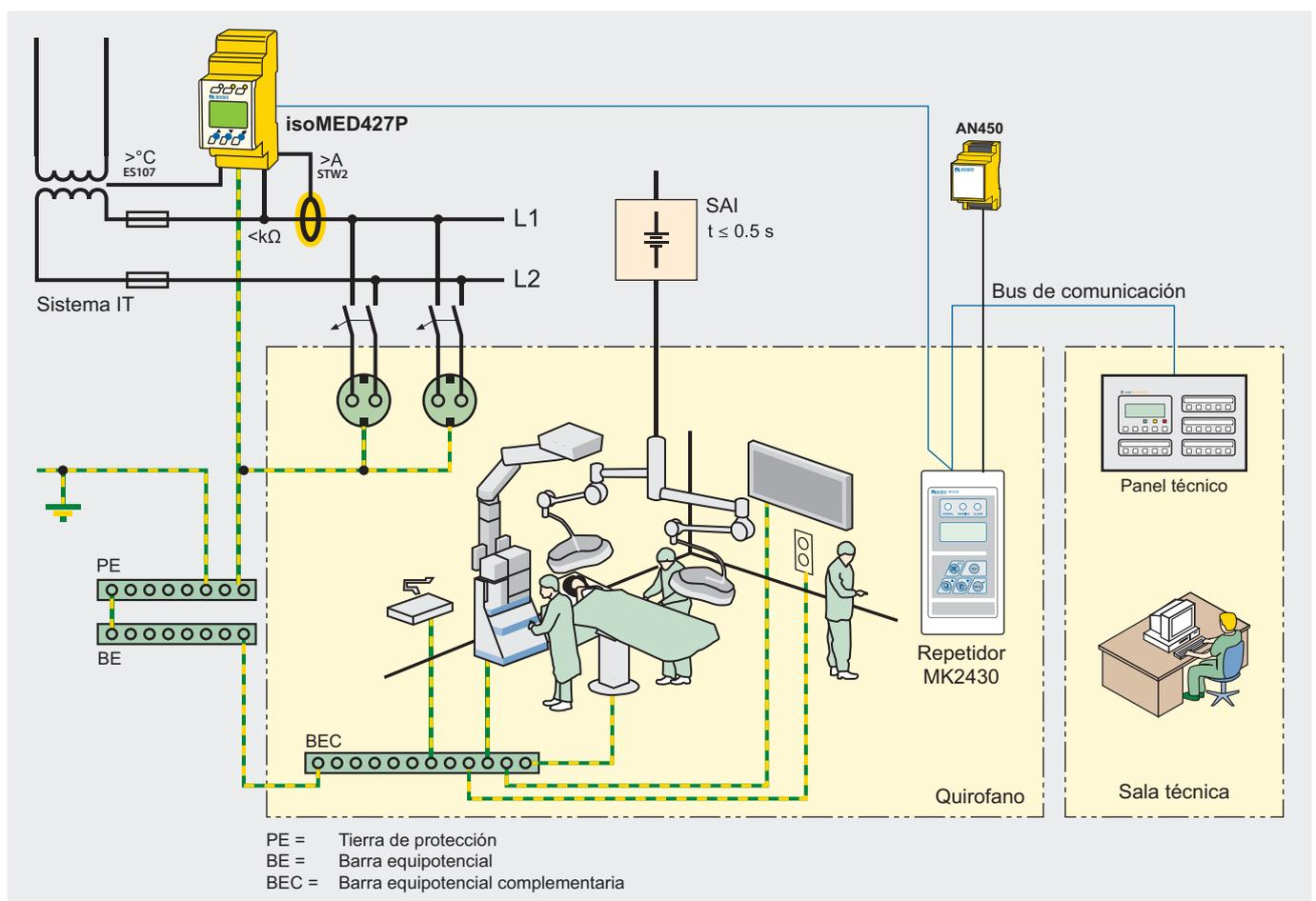
Sistema IT con monitorización de carga y temperatura
