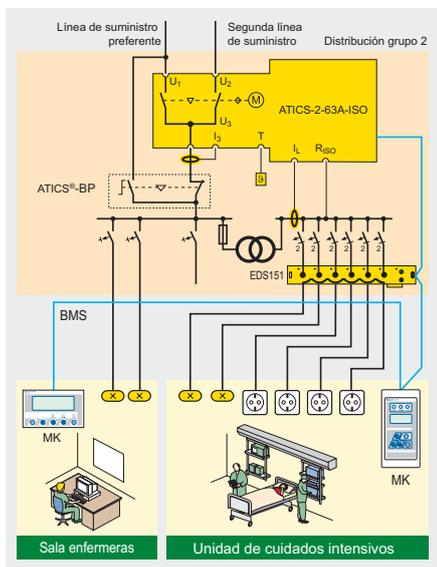
Conmutador para unidades de cuidados intensivos con localizador de fallos de aislamiento (EDS) y conmutador de bypass
