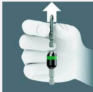
Para cambiar la punta simplemente se ha de desplazar el casquillo hacia adelante: En ese instante, el mecanismo de muelle desprende la punta del imán y desbloquea así la herramienta. La punta se puede extraer sin problema alguno. Y lo que es especialmente útil: esta función también permite la extracción de puntas de dimensiones muy pequeñas sin que se tenga que utilizar herramienta adicional de ayuda.
