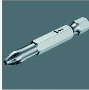
Puntas ACR® viene de Anti-Cam-Out Ribs. Estas puntas disponen de nervios en los extremos de salida, que protegen la punta ante un deslizamiento del tornillo. ACR® es una marca registrada de la empresa Phillips Screw Company.
