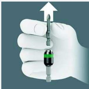
Para cambiar la punta simplemente se ha de desplazar el casquillo hacia adelante: En ese instante, el mecanismo de muelle desprende la punta del imán y desbloquea así la herramienta. La punta se puede extraer sin problema alguno. Esta función también permite la extracción de puntas de dimensiones muy pequeñas sin que se tenga que utilizar herramienta adicional de ayuda.
