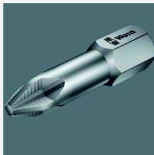
Puntas ACR® viene de Anti-Cam-Out Ribs. Estas puntas disponen de nervios en los extremos de la punta, que protegen la punta ante un deslizamiento del tornillo. ACR® es una marca registrada de la empresa Phillips Screw Company.
