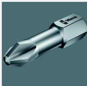
Puntas TZ son puntas tenaces con zona de torsión. Las puntas de torsión amortiguan los picos de par de giro en la zona de torsión. Así se evita un desgaste prematuro, y se aumenta la longevidad de la punta.
