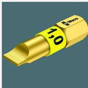
Puntas BDC disponen de una zona BiTorsion más blanda, y así se consigue una reducción de la dureza del vástago en aproximadamente el 20 % con relación al extremo de la punta. De esta forma, se evita las tensiones en el extremo de la punta durante los picos de carga. Estas puntas disponen de un recubrimiento de diamante para reducir el riesgo de
