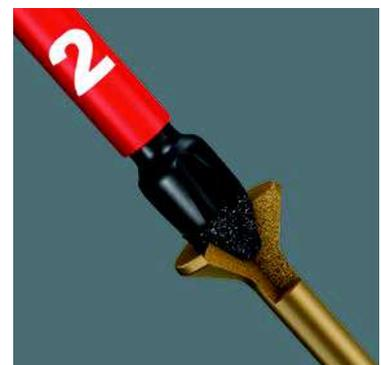
Estas partículas reducen las fuerzas de expulsión que en el caso de trabajos a máquina son especialmente altas y pueden conllevar un deslizamiento de la herramienta saliéndose del tornillo. Las partículas de diamante se aferran fijamente en el tornillo. De esta forma, ya no se tiene que aplicar tanta fuerza de presión lo que reduce claramente la fatiga en trabajos de atornillado.
