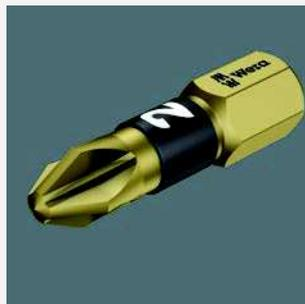
Puntas BTH y BTZ disponen de una zona BiTorsion revenida, y así se consigue una reducción de la dureza del vástago en aproximadamente el 20 % con relación al extremo de la punta.
