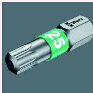
Puntas BTZ disponen de una zona BiTorsion revenida, y así se consigue una reducción de la dureza del vástago en aproximadamente el 20 % con relación al extremo de la punta. De esta forma, se evita las tensiones en el extremo de la punta durante los picos de carga, lo que aumenta aún más la duración de vida de la punta.
