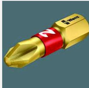
Puntas BDC disponen de una zona BiTorsion más blanda, y así se consigue una reducción de la dureza del vástago en aproximadamente el 20 % con relación al extremo de la punta. De esta forma, se evita las tensiones en el extremo de la punta durante los picos de carga. Estas puntas disponen de un recubrimiento de diamante para reducir
