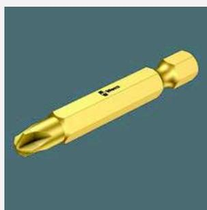
Las partículas minúsculas de diamante que se encuentran en el extremo de la punta, en el proceso de atornillado es como si se aferraran con los dientes en el tornillo. A causa de este alojamiento seguro del útil, ya no hace falta tener que aplicar tanta presión al efectuar el atornillado. Así se reduce el riesgo de que la herramienta se escape del tornillo por deslizamiento.
