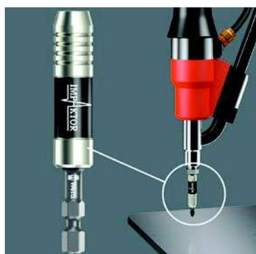
El porta-puntas Impaktor de acero inoxidable con anillo de retención e imán, cumple con las exigencias dinámicas extremas y que a propósito no tiene componentes mecánicos pequeños susceptibles de fallo, sino que se concentra en la función básica y necesaria de sostener la punta, y en la tarea de amortiguar los picos extremos de impulso por medio de dos zonas de torsión diferenciales. Se aplica ante todo en los montajes industriales, por ejemplo atornillados con robots.
