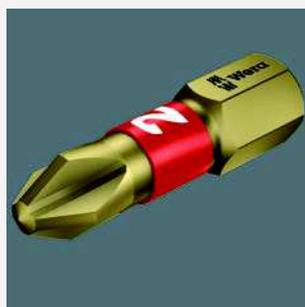
Puntas BTH disponen de una zona BiTorsion revenida, y así se consigue una reducción de la dureza del vástago en aproximadamente el 20 % con relación al extremo de la punta. De esta forma, los picos de par que causan el desgaste y la rotura prematura se absorben en esta zona más blanda, lo que aumenta aún más la duración de vida de la punta.
