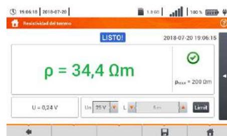
Medición de la resistividad del suelo
