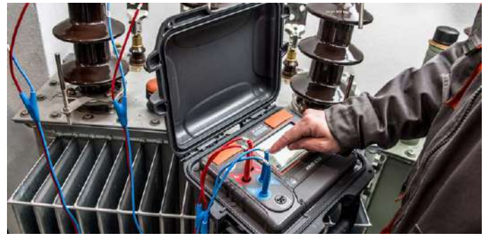
Mediciones mediante el dispositivo MMR-650
