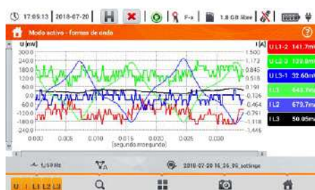
Registrador de los parámetros de alimentación
