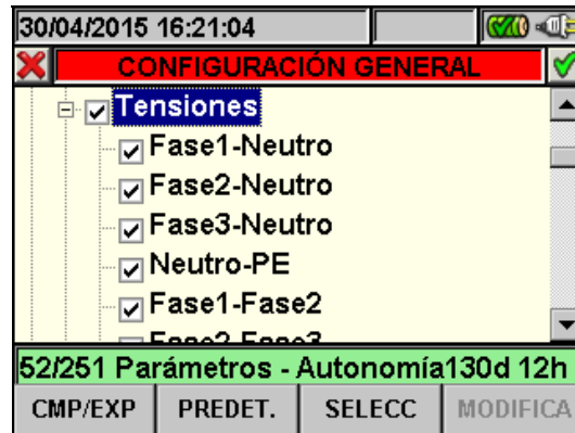
Fig. 60: Subnivel Parámetros Generales - Caso Monofásico
